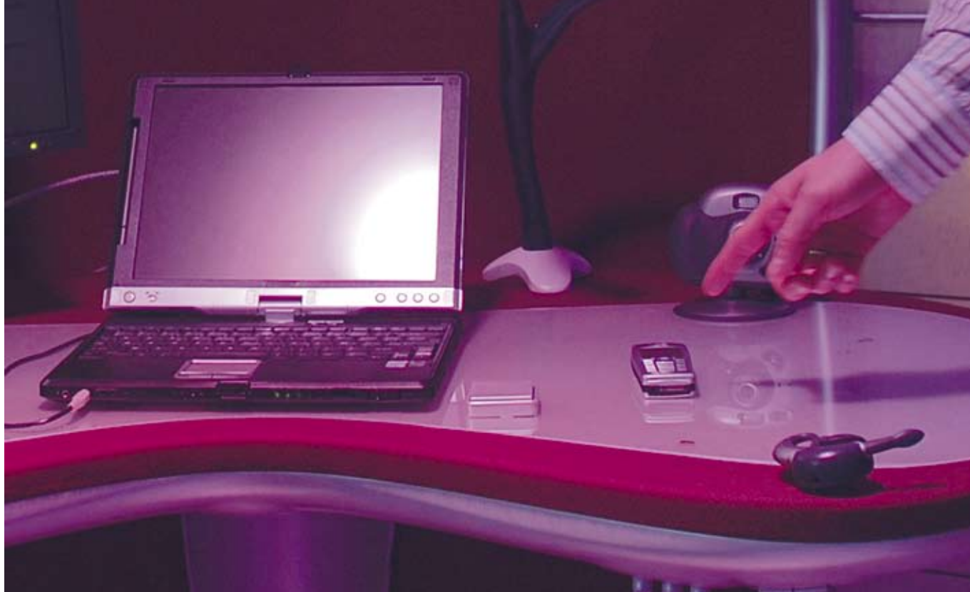
Mobiltelefonen och den bärbara datorn laddas trådlöst genom att placeras på bordet bredvid en induktionsterminal.
