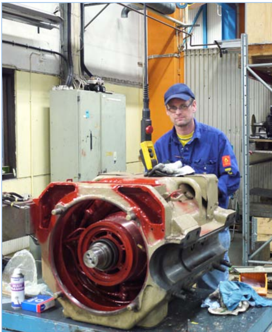
Ovan: NEA:s elektromekaniker Henrik Lindström, monterar främre gavel på drivmotorn.
