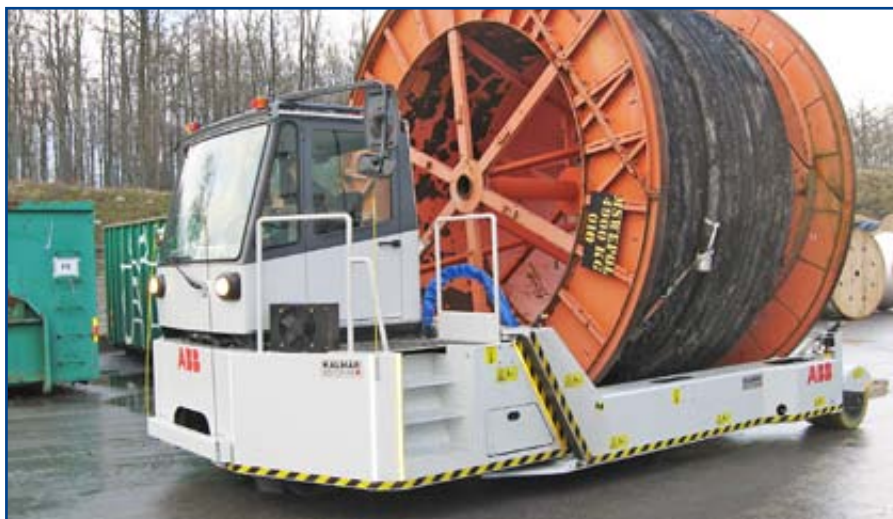
Bilden visar ett specialfordon från Kalmar Motor för transport av kabeltrummor. Kund ABB Karlskrona. Foto via Kalmar Motor.
