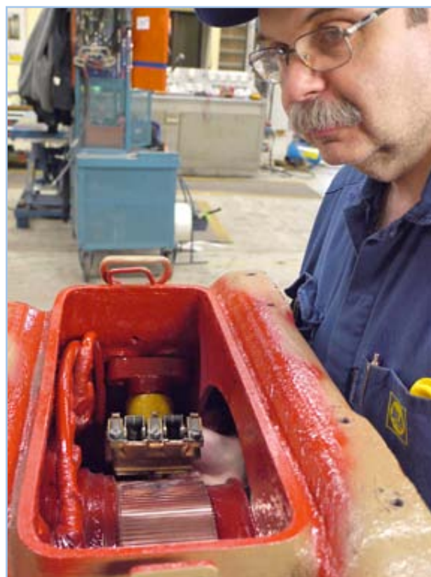
Ovan: NEA:s elektromekaniker Henrik Lindström, monterar främre gavel på drivmotorn.
