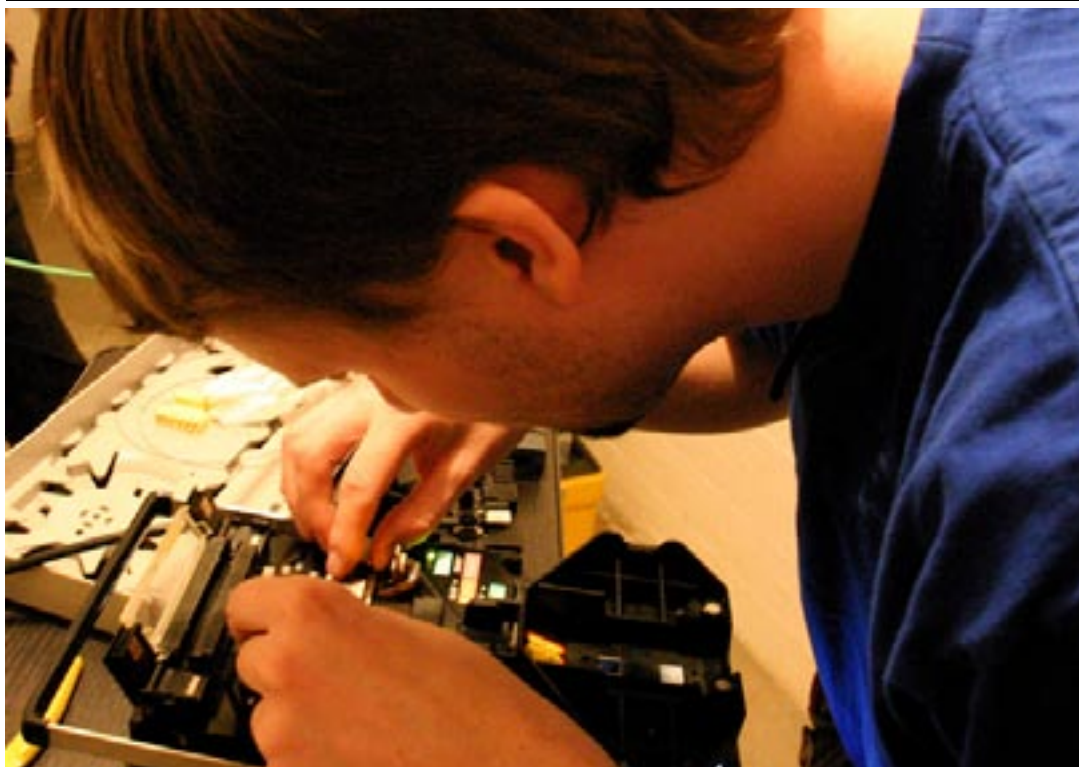
Den partssammansatta arbetsgruppen för ATL-listan har haft en period med studiebesök för att få mer kunskap om material och arbetsmetodik. Här visas fibersvetsning av en medlemen Christian Björkman i Halmstad..
