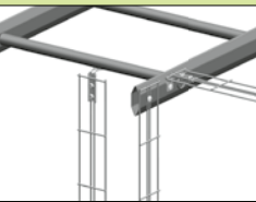
B30-I-stegar monterade på kabelstege.
