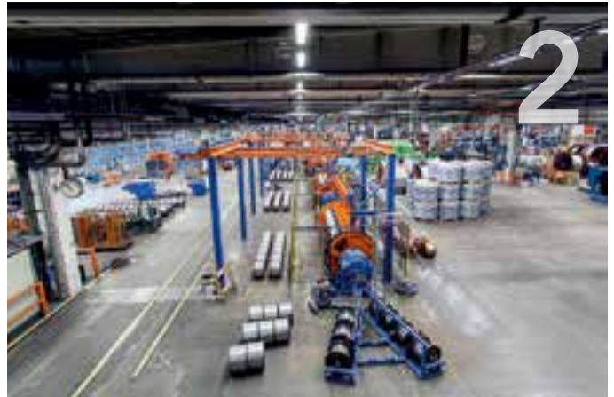
Kablingsmaskin med sju trådar aluminium på väg att bli till en ledare.
