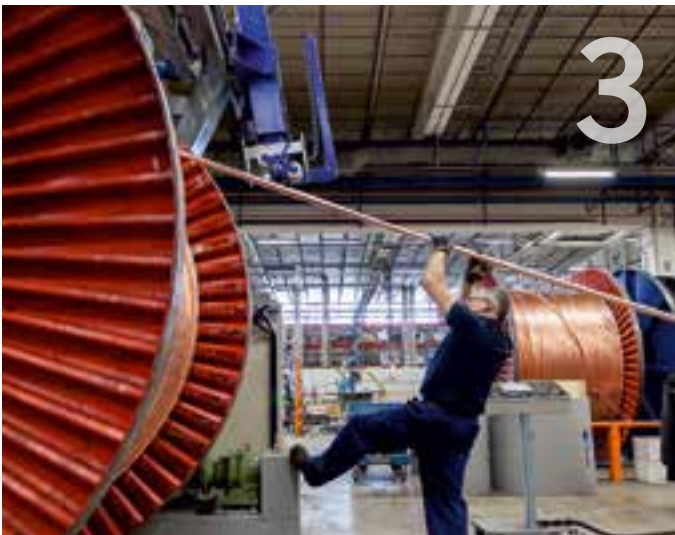
Kabeln dras upp på en upptagartrumma efter att den blivit hopslagen.
