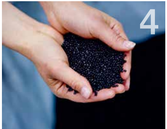
Plastgranulat används som råmaterial både för isolation och mantel.
