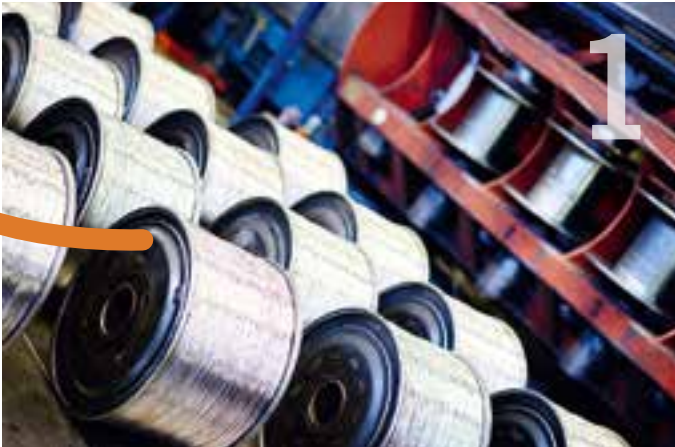
Aluminiumtråd efter att den dragits ut till rätt dimension på dragbordet.
