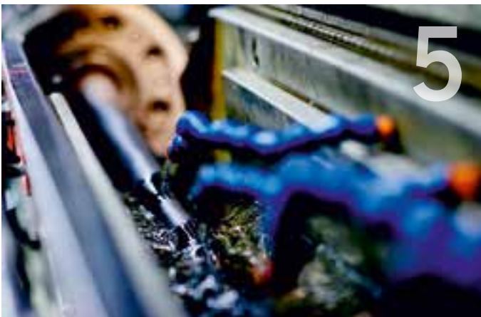
Kabeln dras genom mantlingslinjen så att det skyddande ytterhöljet kommer på plats.
