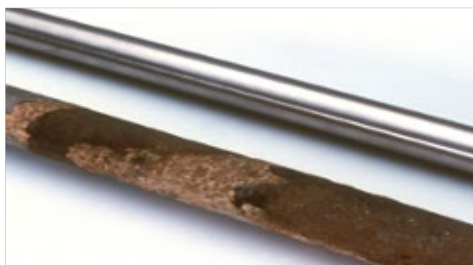
Rostfritt vs varmförzinkat < 5 år
