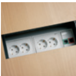
Roterade uttagsbrunnar gör att vinklade kontakter inte krockar
